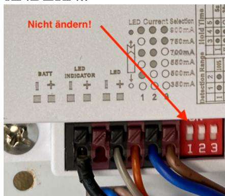
Die Dipschalter 1 bis 12 können entweder in Stellung **oben = Ein** oder **unten = Aus** eingestellt werden. Wählen Sie in der Tabelle die gewünschte Einstellung pro Funktion aus.
