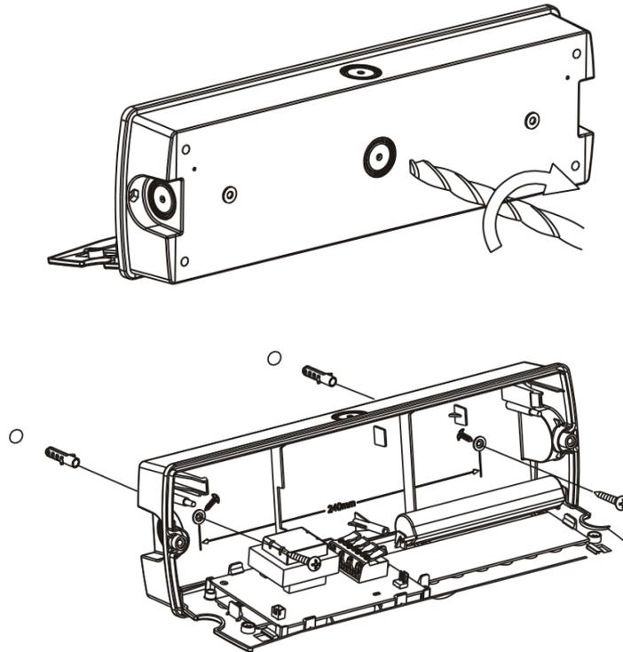
4. **Trennen Sie die Stromversorgung!** und schließen Sie die Leuchte an:
