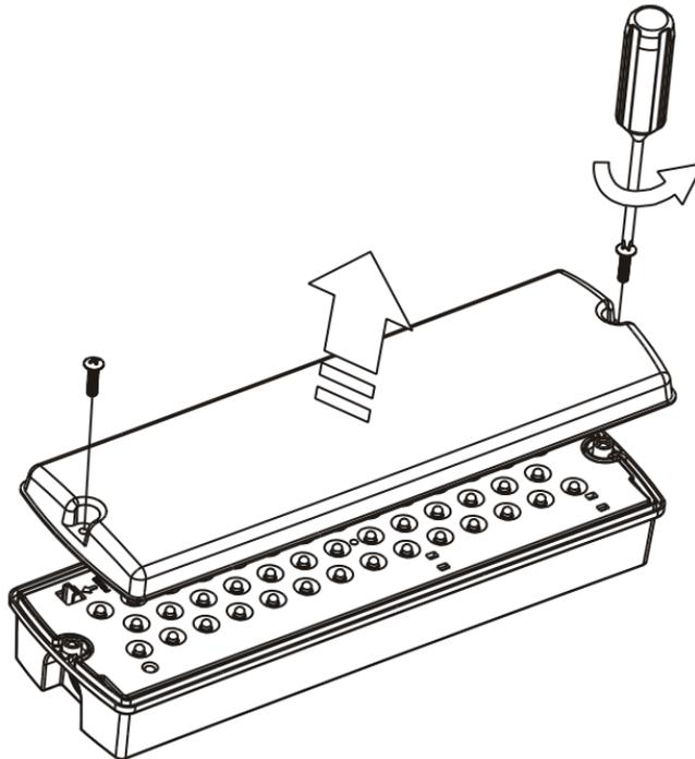
2. Drücken Sie vorsichtig das Kunststoff Gehäuse in der Mitte (Aufkleber „Open →“) zur Seite nach außen und klappen danach die Lichtplatte auf.
