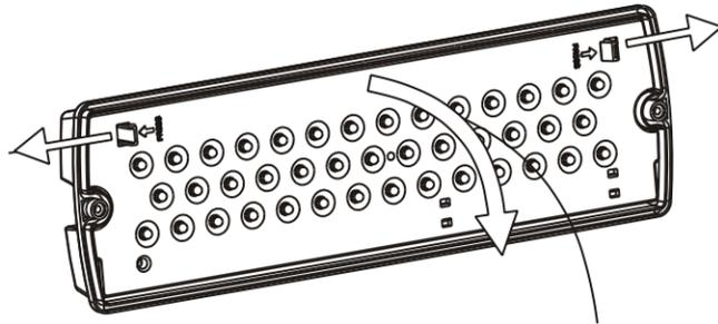
3. Befestigen Sie die Leuchte mithilfe von Schrauben an Wand oder Decke (mehrere Lochmöglichkeiten vorgesehen).
